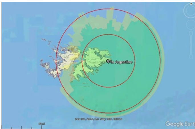
Diagrama de cubrimiento radar para FL 050 (5000 ft) Radar Westinghouse TPS-43 E. Puerto Argentino
